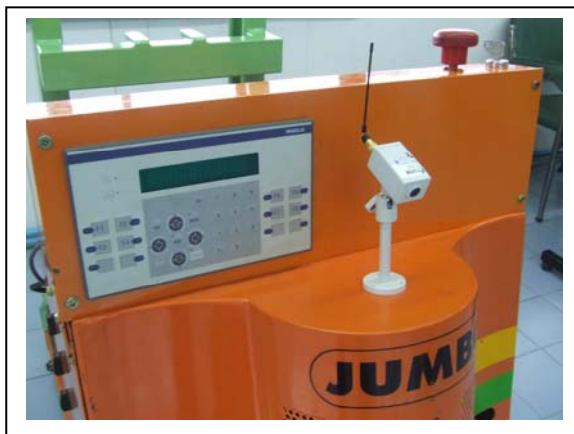
ภาพที่ 3-15 ตำแหน่งในการติดตั้งกล่องซีซีดีไร้สาย
