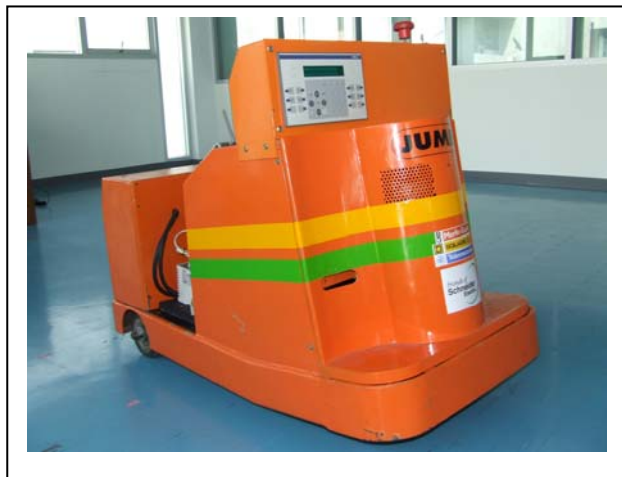
ภาพที่ 3-7 เอจีวีต้นแบบที่ใช้ในการวิจัย
